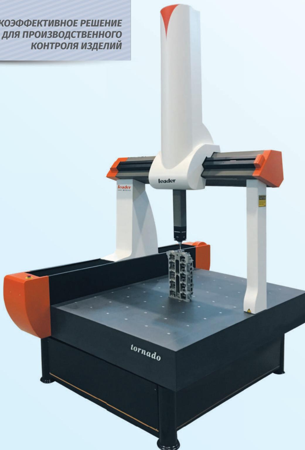
Базовая плита всех координатно-измерительных машин Leader Metrology изготавливается из натурального гранита. Портал КИМ серии Tornado производится из специального алюминиевого сплава. Применение алюминиевого сплава позволяет изготовить подвижный портал КИМ легким и прочным. Вследствие малой массы и инерции КИМ серии Tornado позволяет измерять детали с чрезвычайно высокой скоростью.
