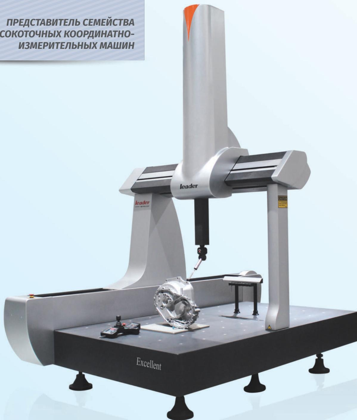
КИМ серии Excellent-P/PH подходит для измерений сверхточных и сверхсложных изделий в таких отраслях, как медицинское оборудование, спутники, авиадвигатели, лопатки турбин, прецизионные детали автомобилей и т.д. На КИМ серии Excellent - P/PH применяются высокоточные линейки и система температурной компенсации от Renishaw.
