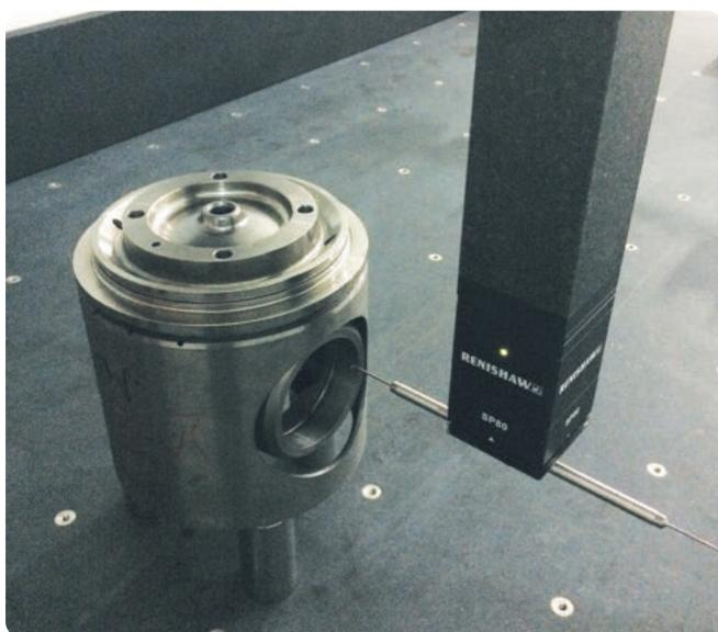
КИМ серии Metroking наилучшим образом соответствуют принципу метрологии Abbe и считаются эталоном высокоточной измерительной машины. Обладая непревзойденной точностью и стабильностью, эта КИМ соответствует требованиям к сканированию и измерению параметров прецизионных деталей и высокоточных поверхностей.
