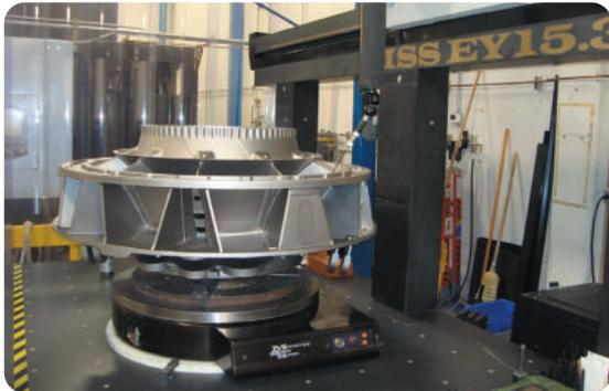
КИМ серии Cruiser обеспечивает максимальный объем измерения для крупногабаритных изделий. Высокая стабильность и точность измерений достигается за счет передовых средств и методов, разработанных профессиональным программным обеспечением, с использованием анализа методом конечных элементов и динамических свойств.
